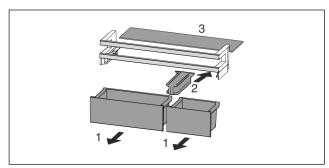
Fig. 57\* Disassemble the door rack.
